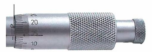
Reading =  $1 \text{ mm} + 0.5 \text{ mm} + 0.14 \text{ mm} = 1.64 \text{ mm} \pm 0.01 \text{ mm}$
